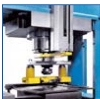
FDM-80/3 E wyposażona w trzy niezależne głowice.
