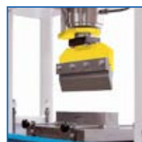
FLM-100 z jedną głowicą obsługującą trzy matryce.
