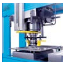
FDM-80/3 E wyposażona w trzy niezależne głowice.
