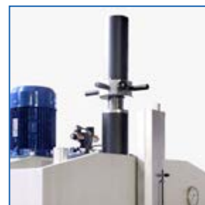
Mechaniczna regulacja do precyzyjnego ustalenia wysokości zejścia siłownika.
